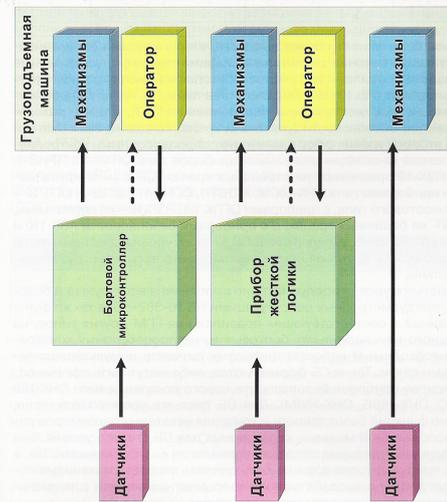
Рис. 2. Структурная схема системы безопасности грузоподъемной машины: — воздействие по цепям управления ГПМ; - - - - - передача информации
