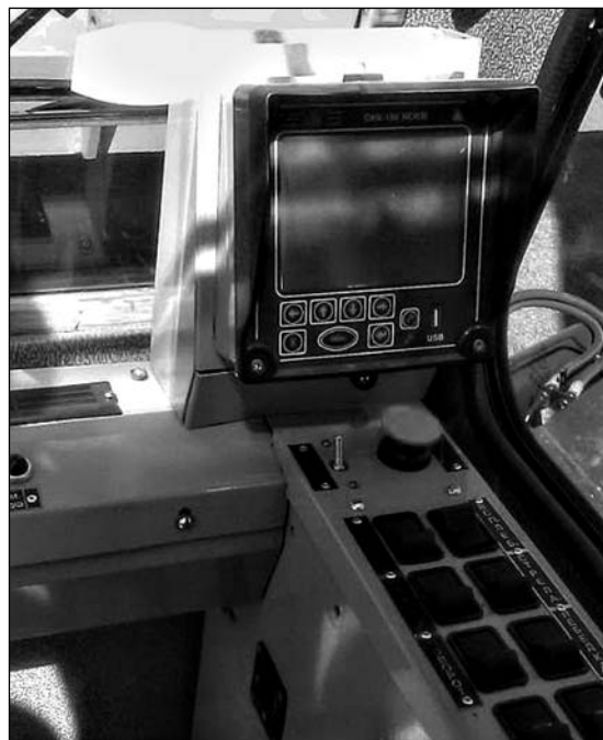
Рис. 7. Модификация ограничителя нагрузки ОНК-160С-97, установленная в кабине автокрана производства ОАО «Газпром-Кран» (г. Камышин)
