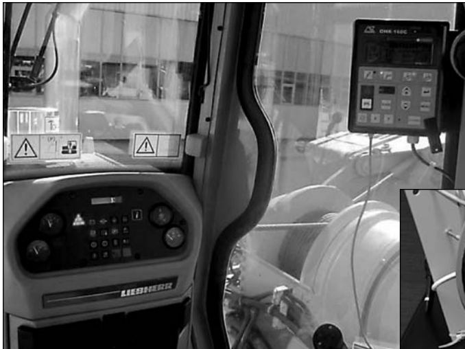
Рис. 2. Настройка прибора ОНК-160С на заводе кранов-трубоукладчиков австрийской фирмы Liebherr-Werk Telfs GmbH
