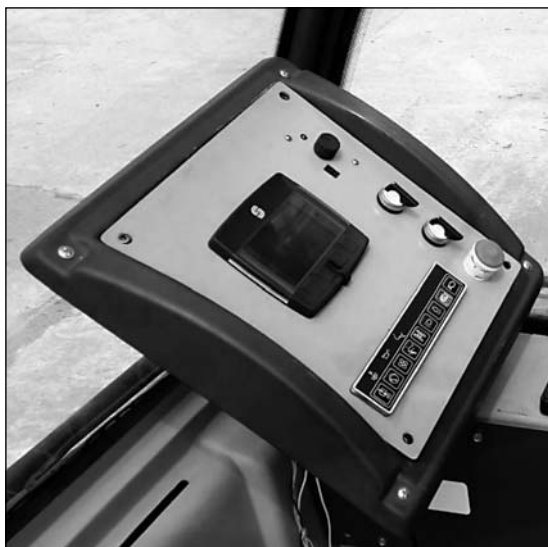
Рис. 11. Настройка дисплея DP250 в кабине гусеничного крана RDK-50T (ОАО «Клинцовский автокрановый завод»)
