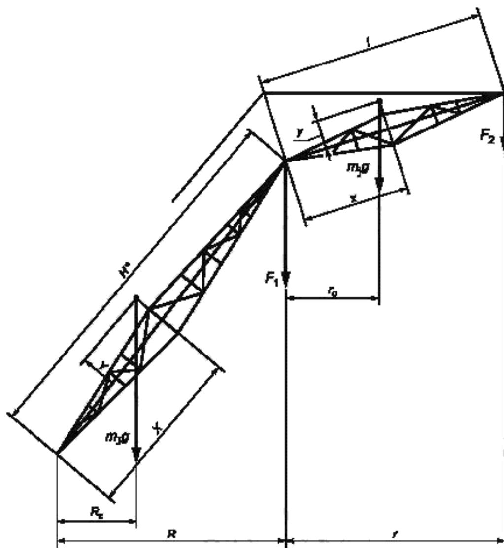
$R$  — горизонтальная проекция стрелы крана;  $r$  — горизонтальная проекция гуська стрелы;  $H^*$  — длина стрелы крана;  $l$  — длина гуська стрелы крана;  $R_c$  — горизонтальное расстояние от точки крепления до центра тяжести стрелы крана;  $r_c$  — горизонтальное расстояние от точки крепления до центра тяжести гуська стрелы;  $X, Y$  — координаты центра тяжести стрелы крана;  $x, y$  — координаты центра тяжести гуська стрелы крана
